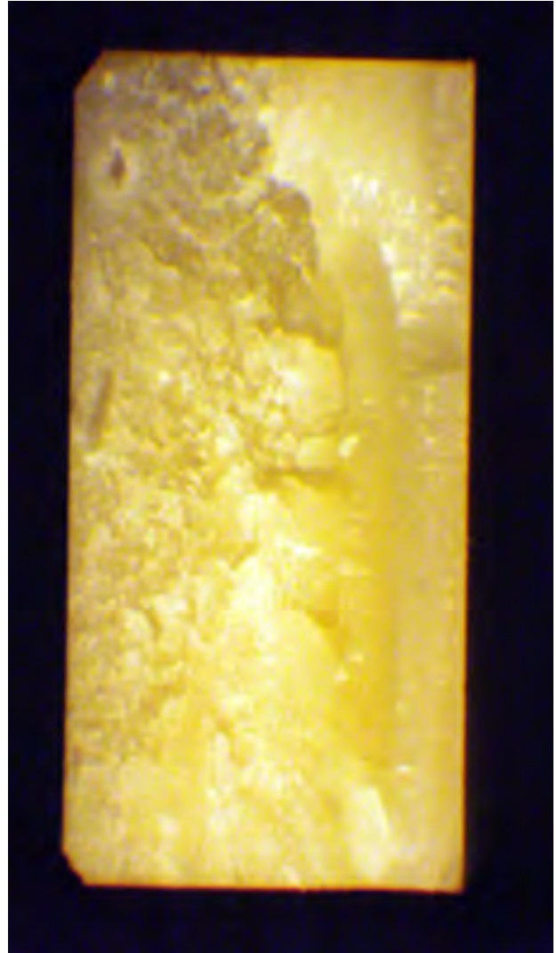
شکستگی سطحی پس از ضربه (۴*۶ mm)
