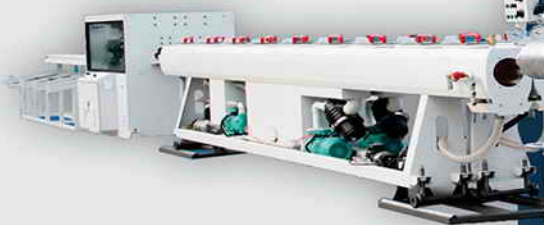
خطوط تولید لوله های پلی اتیلن P.E pipe production line
