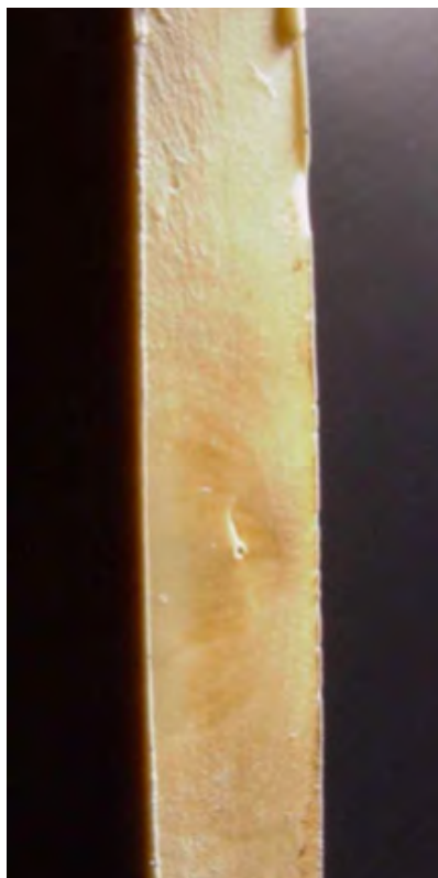
شروع رشد ترک از ناهمگونی در دیواره لوله
